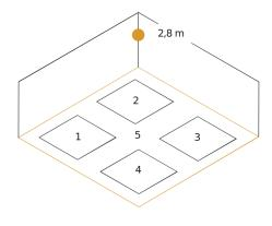
Possibile altezza di montaggio: 2,30 m – 5,00 m  $\,$
